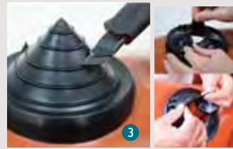
Cortar el collarín horizontalmente por encima de la línea del borde hasta el tamaño requerido. La parte superior del collarín puede retirarse manualmente con cuidado. Cut the collar horizontally above the border line to the required size. The upper part of the collar can then be removed carefully by hand. Couper le collier horizontalement au-dessus de la ligne du bord jusqu'à la taille requise. La partie supérieure du collier peut alors être retirée manuellement en faisant attention.
